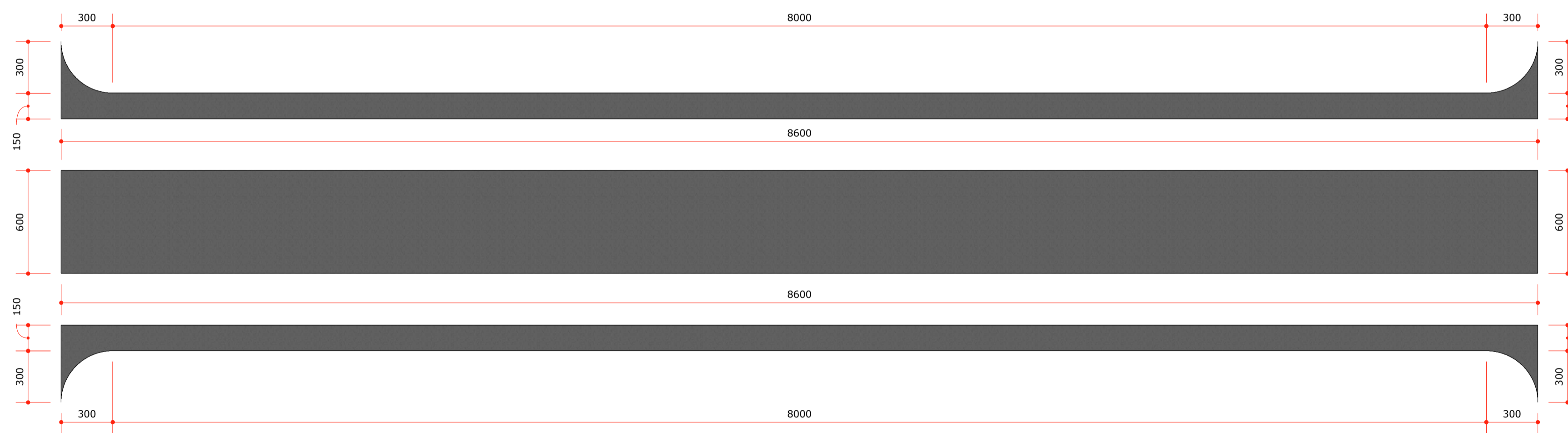
28 RUAS 02 À 05 PLANTA DA CAMADA DE CBUQ 3CM COM PINTURA DE LIGAÇÃO CONFORME DETALHAMENTO "A" ESCALA 1/200
