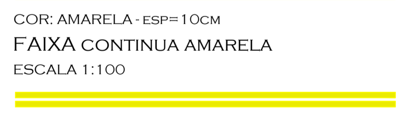
COR: AMARELA - ESP=10CM FAIXA CONTINUA AMARELA ESCALA 1:100
