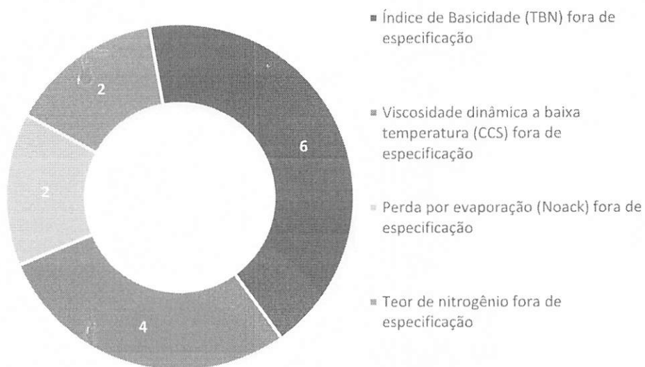
Figura 8. Número de amostras não conforme para os ensaios Viscosidade dinâmica à baixa temperatura (CCS), Índice de Basicidade (TBN), Perda por Evaporação (Noack), Viscosidade a alta temperatura e alto cisalhamento (HTHS).
