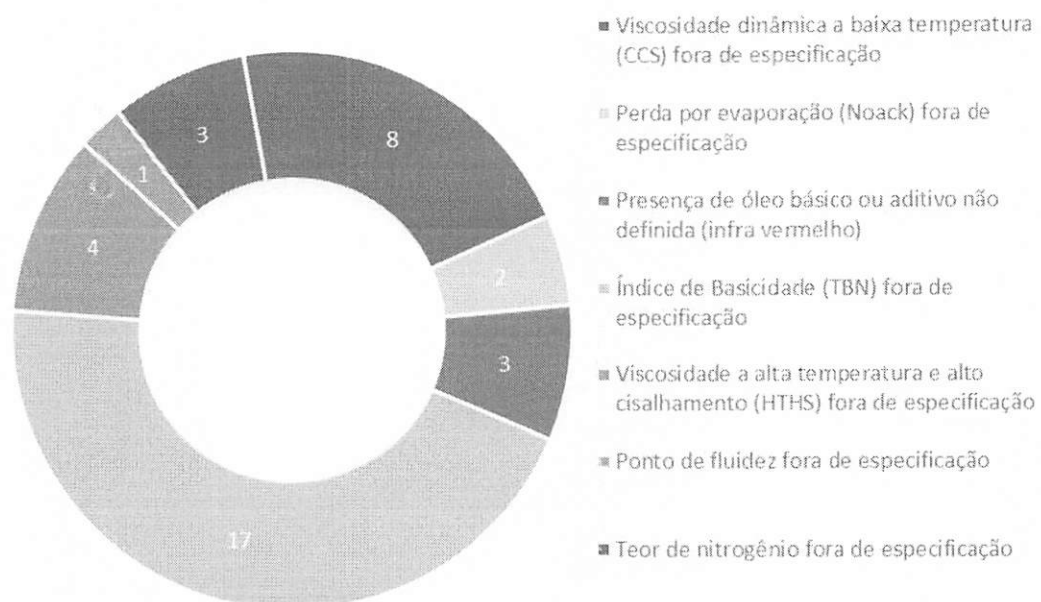
Figura 8. Número de amostras não conforme para os ensaios Viscosidade dinâmica à baixa temperatura (CCS), Índice de Basicidade (TBN), Perda por Evaporação (Noack), HTHS e Infravermelho (FT-IR).
