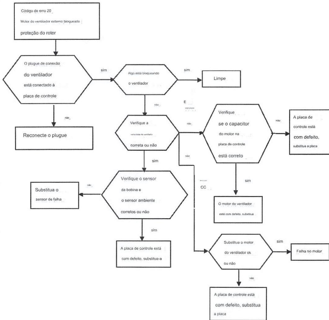
Ponto de teste do motor do ventilador DC:
