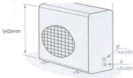
UNIDADE EXTERNA (CONDENSADORA) 26,5 kg
