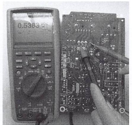
Teste reverso do IPM PU/PV/PW:
