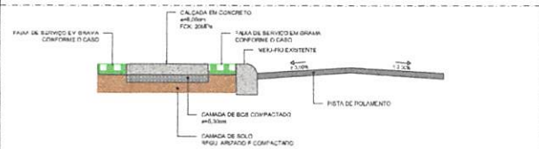
2 DETALHE CALÇADA SEM ESCALA
