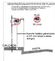
2 DETALHES SINALIZAÇÃO SEM ESCALA
