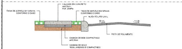
2 DETALHE CALÇADA SEM ESCALA
