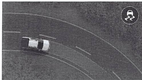
controle de estabilidade Corrige automaticamente a trajetória do seu carro para evitar derrapagens perigosas.
