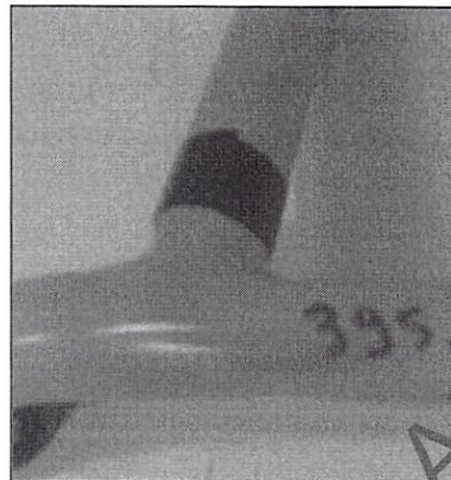
Foto 10 – Amostra da cadeira com região de solda antes do ensaio
