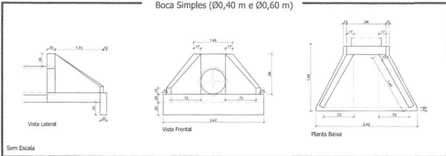
Bueiro Simples Tubular de Concreto Boca Simples (Ø0,40 m e Ø0,60 m)
