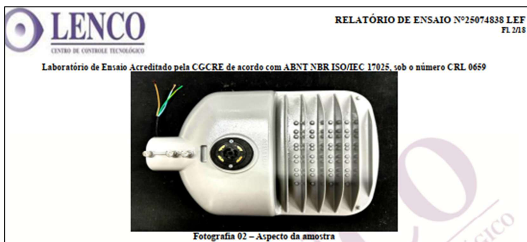
Figura 6 - Luminária de 200W LD 8P-200-4000-170SV, apresentada para validar os ensaios de segurança sob o documento REEME - Luminária Pública LD 8P-200-4000-170-SV - 25074838 LEF.pdf.
