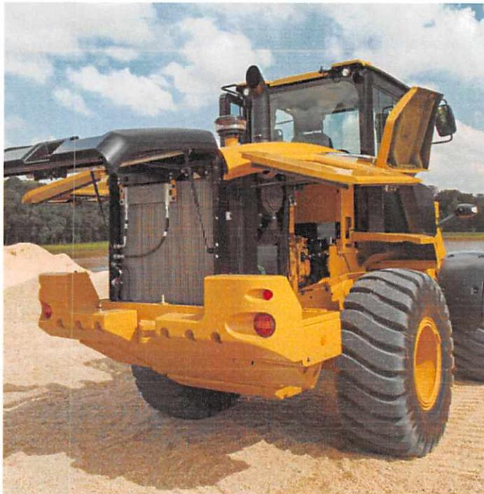
Todos os pontos de manutenção são acessíveis no nível do solo. Três portas de serviço grandes podem ser abertas em qualquer ordem para dar acesso total aos filtros e pontos de manutenção. Intervalos de serviço estendidos reduzem o tempo de serviço e maximizam o tempo de atividade. As características de serviço adicionais incluem:
